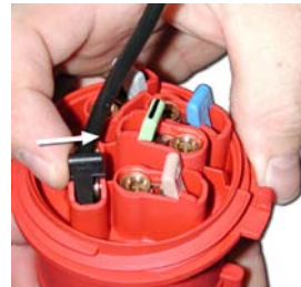
Kuva 6: Laukaistaan lukitusliitin painamalla sitä nuolen osoittamaan suuntaan.
